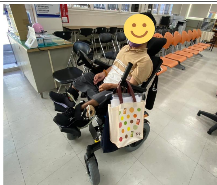
電動輪椅具電動變換姿勢功能，以利久坐減壓
